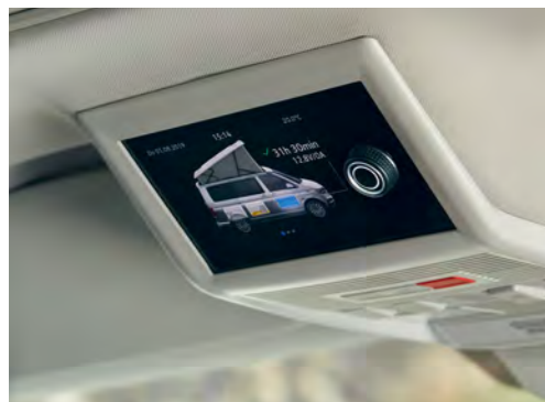
Kontrola stavu energie a stavu pitné vody v nádrži
